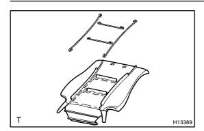
(d) Disconnect the seat wires.
