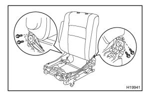
(d) Install the seatback assembly with the 4 bolts.
