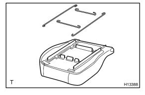
(d) Disconnect the seat wires.
